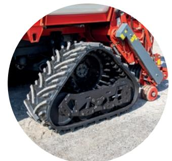
**Raupenlaufwerk für reduzierten Bodendruck**
